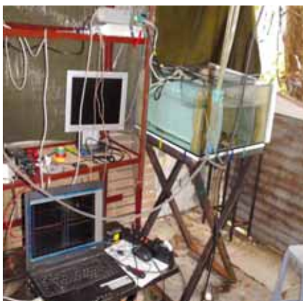
Экспериментальная установка (2009, Кан Тхо). Видеосъемка производится через дно аквариума
